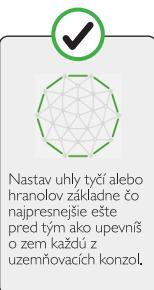
Ked' sa ti páči rozloženie a umiestnenie základne kupoly, pripievní uzemňovacie konzoly dvoma kotviacimi klincami.
